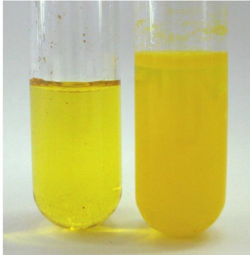
Abb. 3 - Nachweis von Aceton mit einer sauren 2,4-Dinitrophenylhydrazin Lösung (rechts); Vergleichslösung (links)
