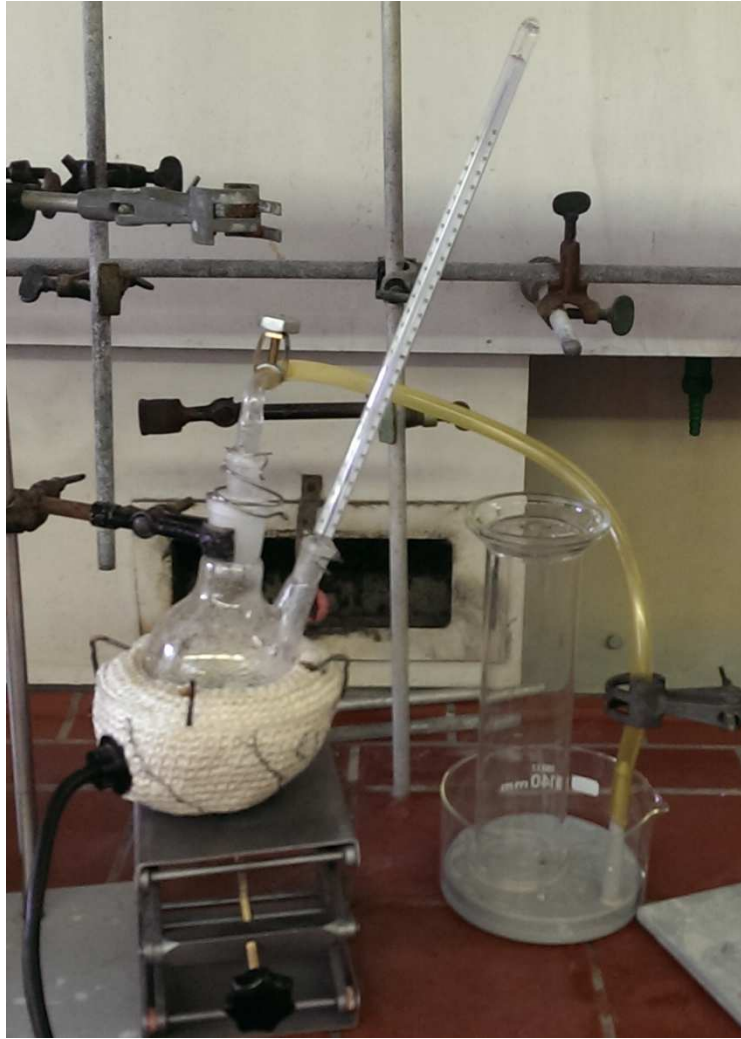
Abb2. - Versuchsaufbau zur Herstellung von Ethen
