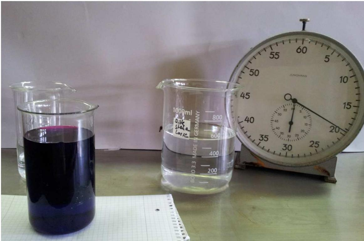
Abb. 2 - vorne: Mit 250 mL Wasser verdünnte Lösung vor dem Farbumschlag, hinten-links: bereits abragierte unverdünnte Lösung, hinten-rechts: noch zu messende Lösung mit 500 mL Wasser verdünnt
