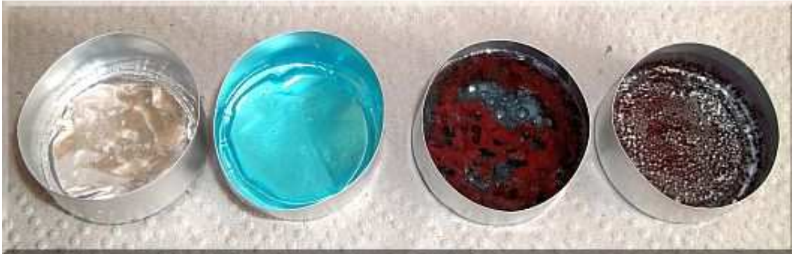
Abb. 7: Versuchsbeobachtung „Katalytische Säure-Korrosion von Aluminium“ (nach 20 Minuten)
