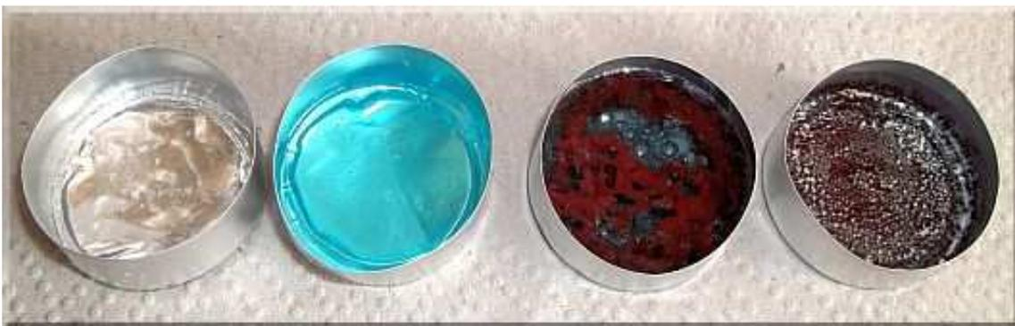
Abb. 7: Versuchsbeobachtung „Katalytische Säure-Korrosion von Aluminium“ (nach 20 Minuten)
