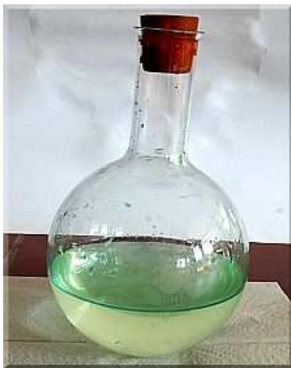
Abb. 3: Versuchsaufbau „Blue Bottle“ vor dem Schütteln
