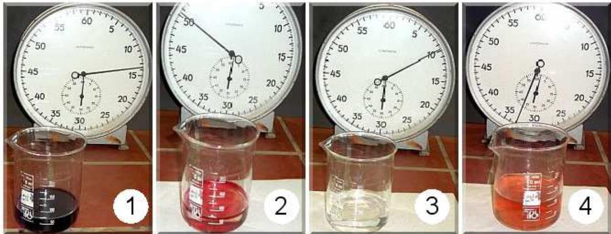
Abb. 8: Versuchsbeobachtung „Autokatalyse“
