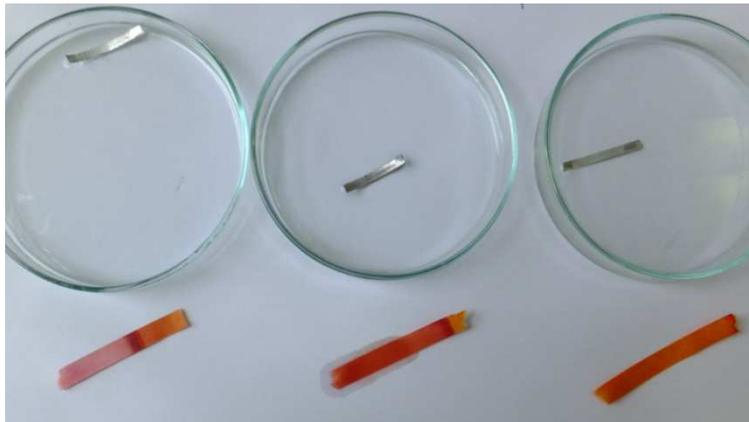
Abb 5: Reaktion von Methan-, Ethan-, Propansäure (von links) mit Mg-Band und Indikatorpapier
