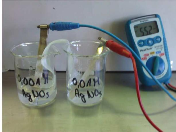
Abbildung 1: Potenzialdifferenzmessung bei zwei unterschiedlich konzentrierten Halbzellen.
