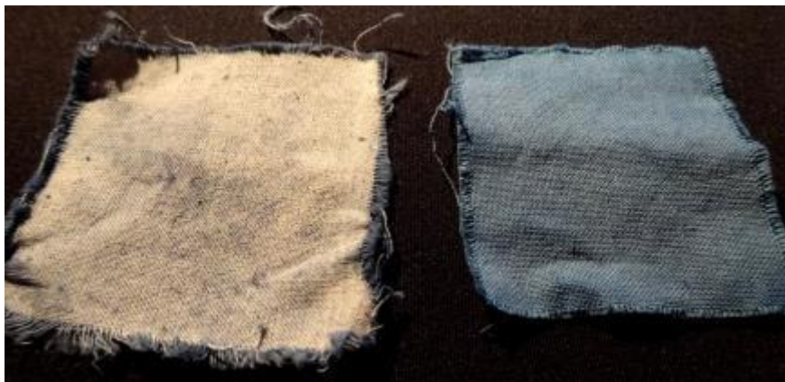
Abb. 2 – Mit Indigo gefärbte Baumwolle (links) und mit Leukoindigo gefärbte Baumwolle (rechts).
