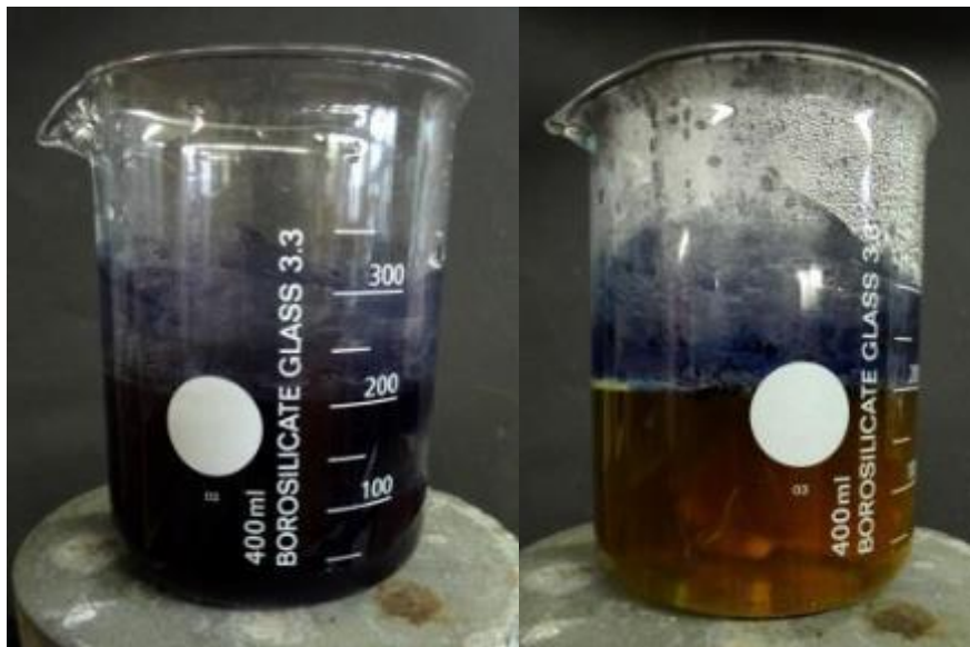
Abb. 1 – Färben von Baumwollstoffen mit Indigo (links) und mit der reduzierten Leukoindigoform (rechts).
