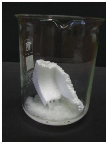
Abb. 4 – Auflösen von Styropor in Aceton.
