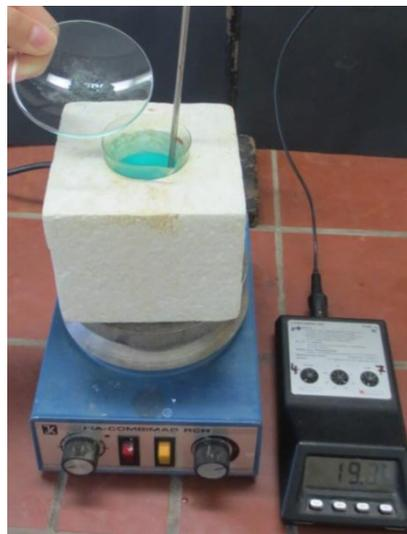
Abb. 5- Zugabe des Zinkpulvers zur Kupfer(II)sulfat-Lösung
