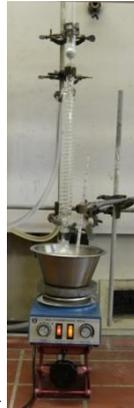
Abb. 7 - Aufbau der Apparatur für die Aspirinherstellung.
