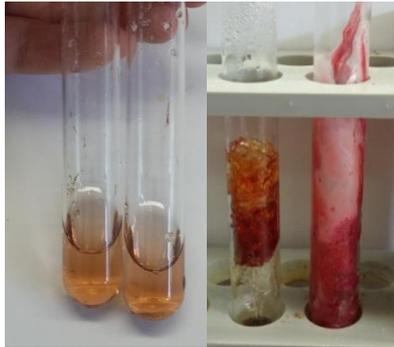
Abb. 6- Resorcin und Formaldehyd vor und nach der Kondensation. Auf dem rechten Bild ist links die Kondensation mit Natronlauge als Katalysator, rechts die Kondensation mit Salzsäure.
