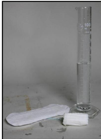
Abbildung 1: Hygieneartikel nach der Aufnahme von Wasser in der maximalen Menge.
