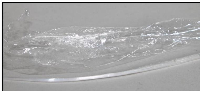
**Deutung:** Durch die Dehnung werden die Polymere parallel zueinander ausgerichtet, sodass sich viele van-der-Waals-Kräfte ausbilden können. Diese müssen überwunden werden, um die Folie zu zerreißen.
