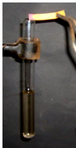
Abb. 1 - Toluol und Brom nach der Zugabe von Eisen; das aufsteigende Gas färbt das angefeuchtete Indikatorpapier rot.
