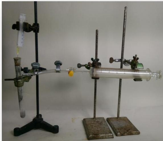
Abbildung 2: Versuchsaufbau zur Messung der Reaktionsgeschwindigkeit bei Zimmertemperatur.
