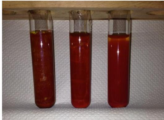
Abb. 7 – FEHLING -Probe mit Fructose, Glucose und Galactose.
