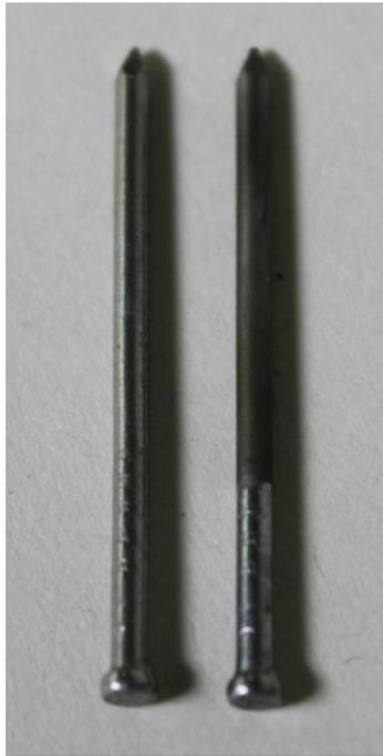
Abb. 4 - Eisennagel und verzinkter Eisennagel.
