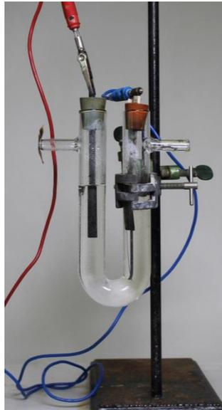
Abb. 1 - Versuchsaufbau Chloralkalielektrolyse.
