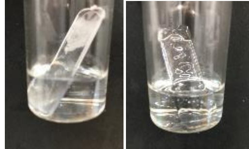
Abbildung 7: Löslichkeit in Aceton am Beispiel von Polystyrol kurz nach Zugabe von Aceton zu Polystyrol (links) und nach einigen Minuten (rechts).
