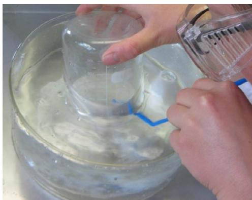
Abbildung 1 Pneumatisches Auffangen der verbrauchten Atemluft
