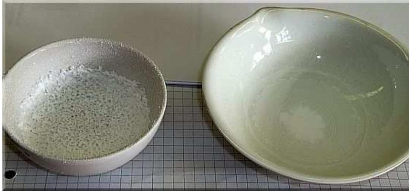
Abb. 2: links: Abdampfschale mit Speisesalz; rechts: Abdampfschale mit Kalkwasser (jeweils nach dem Verdampfen von Wasser)
