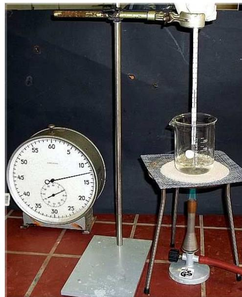
**Beobachtung:** In beiden Bechergläsern siedet das Wasser nach kurzer Zeit. Im Becherglas mit dem dest. Wasser ist nach Ende der Messung kein Rückstand erkennbar, die maximal erreichte Temperatur beträgt 98 °C. Im Becherglas mit der Kochsalzlösung ist eine Dampfbildung erkennbar. An den Wänden des Becherglases lagert sich ein weißer Feststoff ab. Die maximal erreichte Temperatur liegt bei 104 °C.
