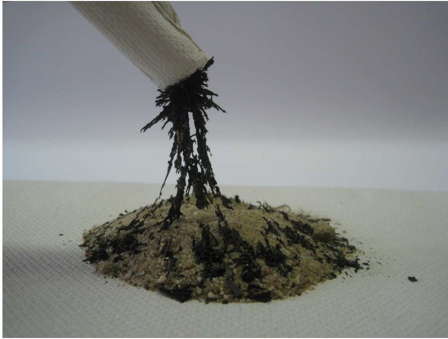
Abb. 2: Die Eisenspäne werden von dem Magneten angezogen.
