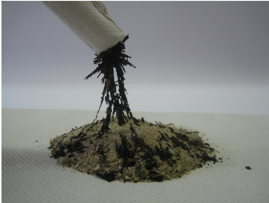
Abb. 2: Die Eisenspäne werden von dem Magneten angezogen.
