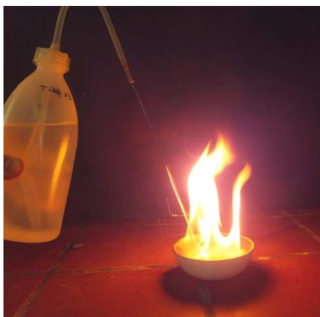
Abb 1: Löscharversuch von brennendem Benin mit Wasser.
