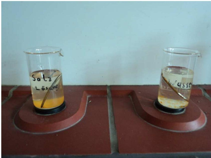
Abb. 9 - Die Eisennägel nach einigen Stunden
