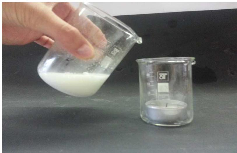
Abb. 4 - Das CO<sub>2</sub> löscht die Kerze
