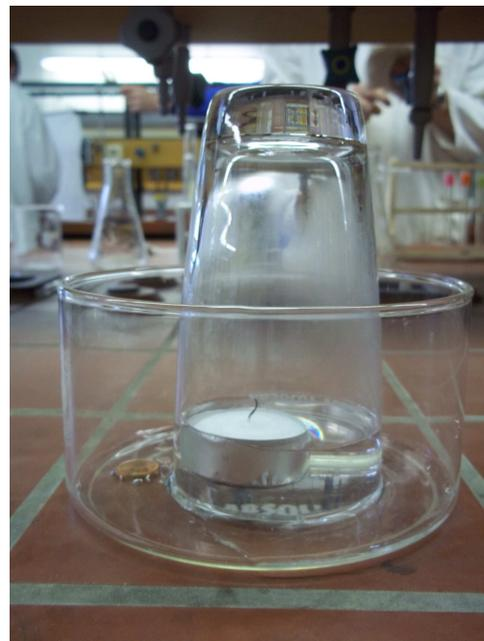
Abb. 7 und 8 - Ein Teelicht als Wasserpumpe
