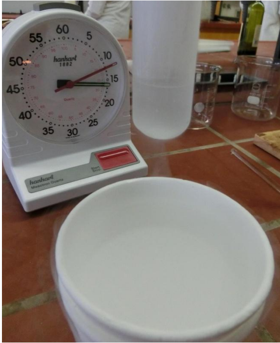
Abb. 2 - Flüssige Luft aus Versuch 2
