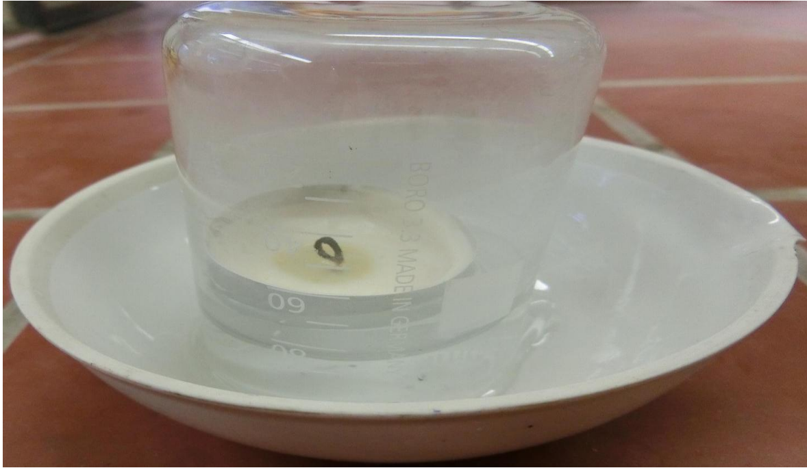
Abb. 5- Teelicht mit in ein Becherglas gesaugtes Wasser von Versuch 5
