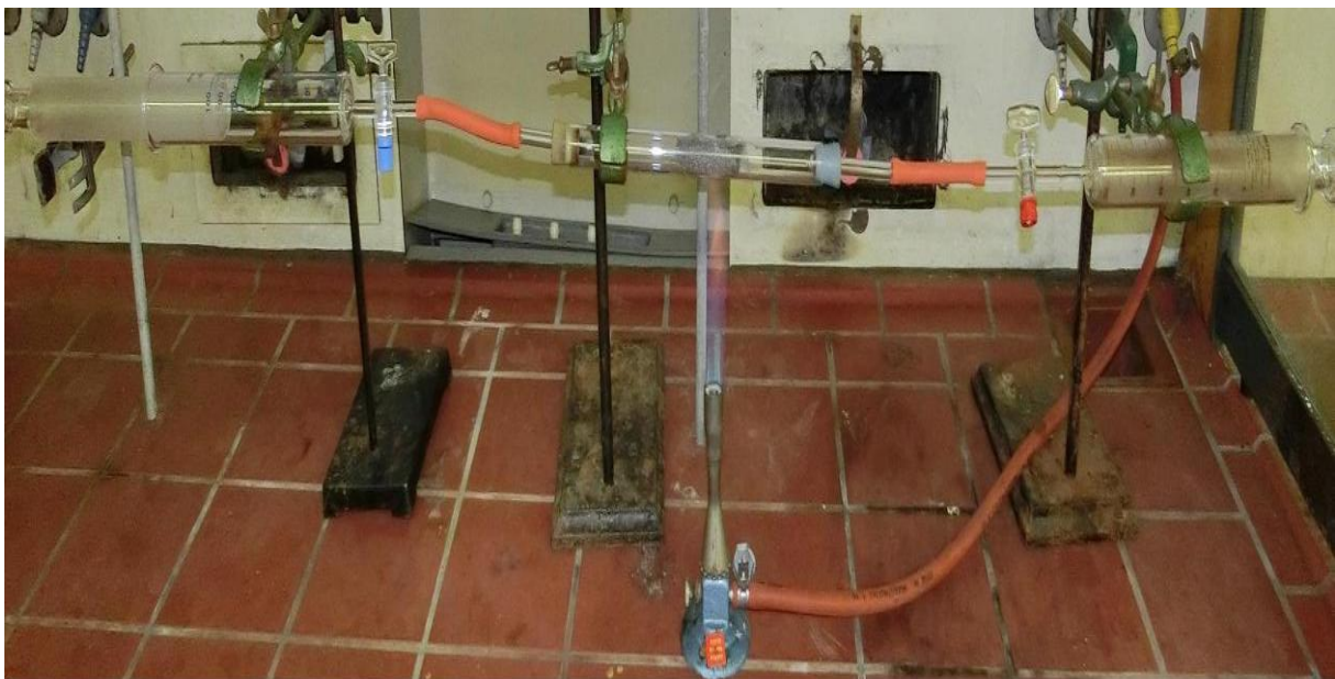
Abb. 6 - Aufbau zu Versuch 6; zwei Kolbenprober an einem Verbrennungsrohr mit Eisenwolle
