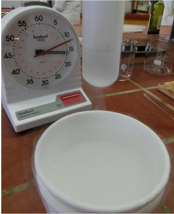
Abb. 2 - Flüssige Luft aus Versuch 2
