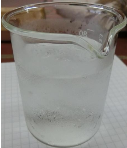
Abb. 3 - Kondensiertes Wasser an einem Becherglas für Versuch 3.
