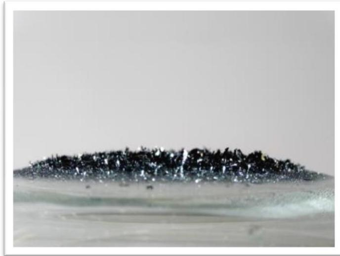
Abbildung 2: Resublimierte Iodkristalle an der Rückseite des Uhrglases
