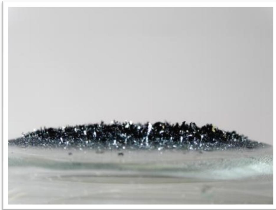
Abbildung 2: Resublimierte Iodkristalle an der Rückseite des Uhrglases
