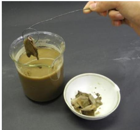
Abbildung 1: Die aufgeweichten Papierstücke werden mechanisch aus der Lösung entfernt.
