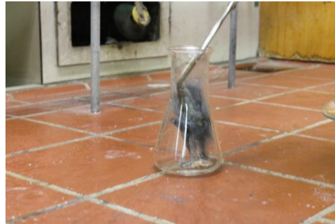
Abb. 1 Versuchsaufbau (oben) mit Glimmspanprobe vorher (links) und im Erlenmeyerkolben (rechts).
