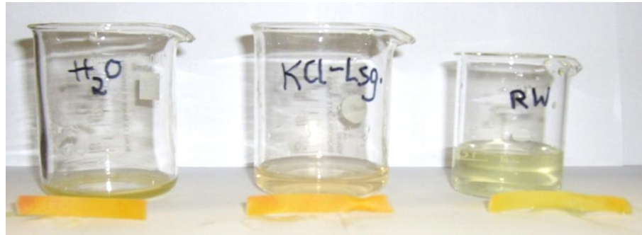
Abb. 6 - Gartenerdefiltrate (Lsgm.: Wasser, links; Lsgm.: Kaliumchloridlösung: mittig) und Regenwasser (rechts) mit zuvor eingetauchten Indikatorpapierstückchen.
