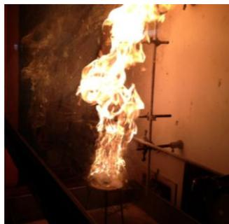
Abb. 4 – Durch Wasser wird der Brand des Paraffinöls verstärkt.
