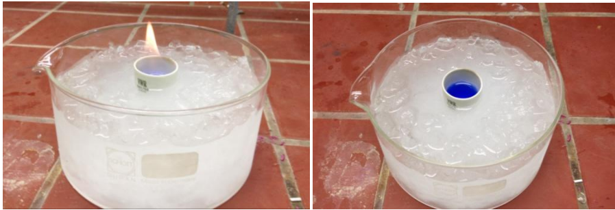
Abb. 1 - Löschen eines Petroleumbrandes mittels einer Eis-Viehsalz-Mischung.
