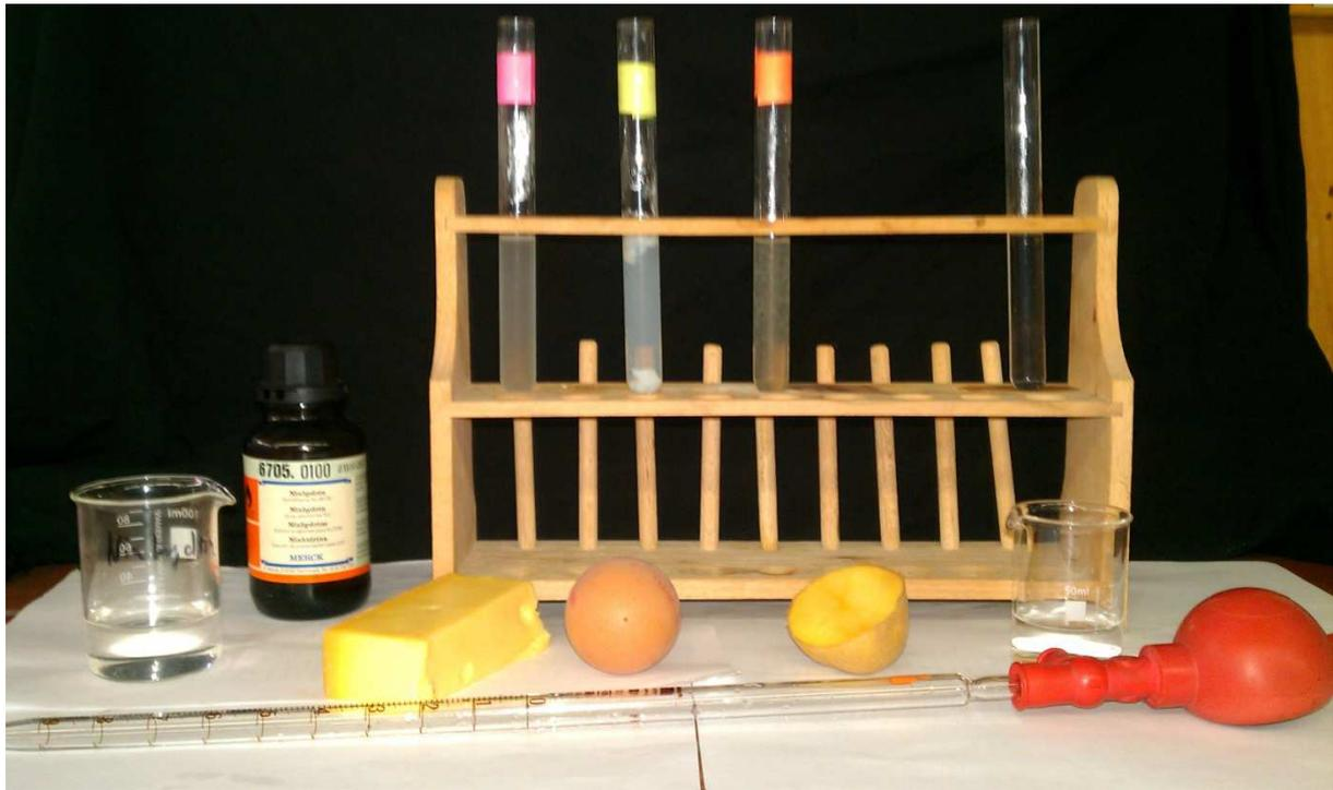
Abbildung 2 – Lebensmittellösungen mit Ninhydrinlösung versetzt
