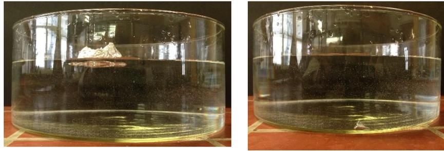
Abb. 4 – Schwimmendes Alu-Boot (links) vs. Nicht schwimmende Alu-Kugel (rechts)
