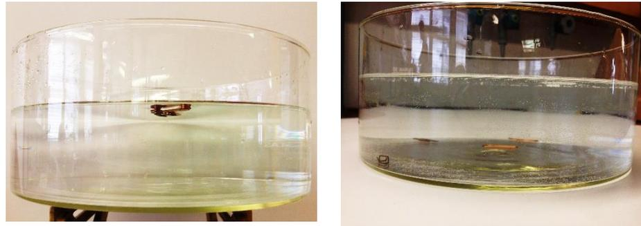
Abb. 2 – Büroklammern schwimmen auf der Wasser (links), vs. Büroklammer sinken nach Zugabe von Spülmittel (rechts).
