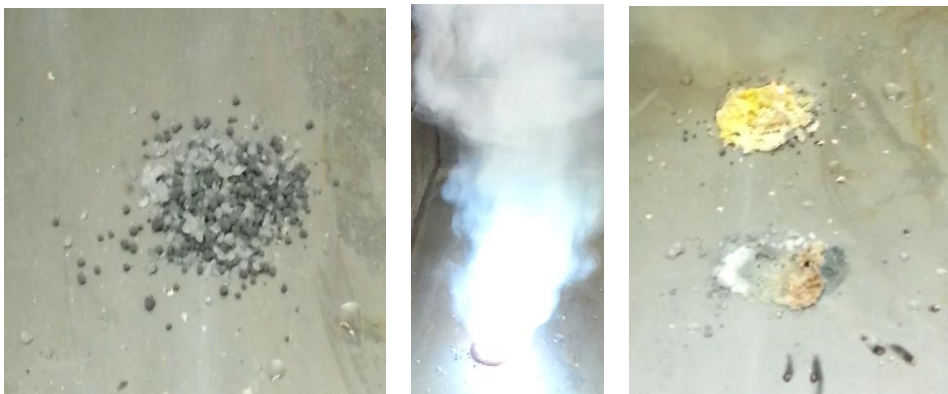
Abb. 1 - Feststoffgemisch vor der Wasserzugabe, Gemisch während des Brennens, Feststoffgemisch nach Verbrennung (oben: Variante 1, unten: Variante 2).
