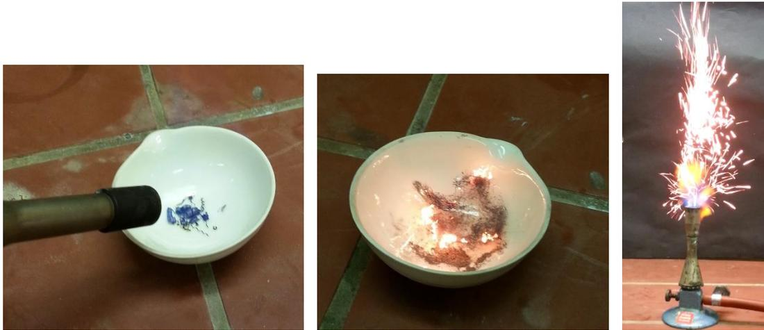
Abb. 1 – Eisenspäne (links), Brennende Eisenwolle (Mitte), Eisenpulver in Brennerflamme (rechts).
