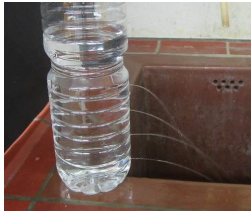
Abbildung 1: Flaschenstaudamm aus einer PET-Flasche.
