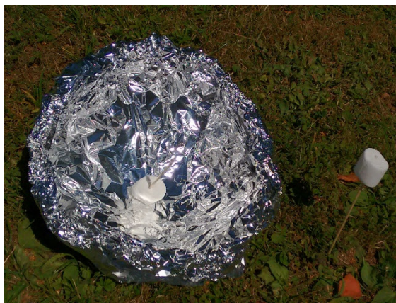
Abbildung 1: Marshmallow-Ofen aus Alufolie und Sonnenenergie.
