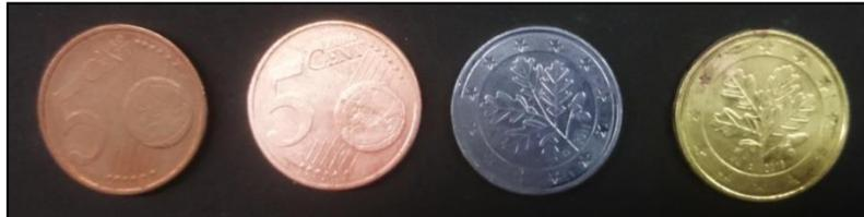
Abbildung 2 - (rechts nach links) unbehandelte Kupfermünze, gereinigte Kupfermünze, Kupfermünze nach Reaktion mit der Natriumhydroxidlösung und Zinkpulver, erhitzte Kupfermünze.
