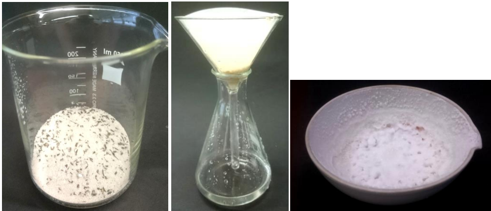
Abb. 1 - (von links nach rechts) Gemenge. Lösung nach dem Filtrieren. Zurückgebliebenes Salz nach dem Abdampfen des Wassers.
