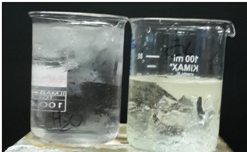
Abbildung 1: Schwimmfähigkeit von Eis in Wasser (links) und Öl (rechts).
