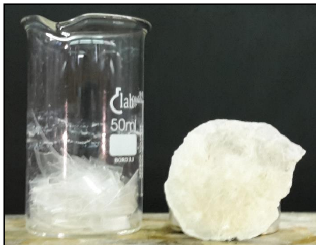
Abbildung 1: Becherglas mit zerkleinertem Plastikbecher und umgeformtes Polyethylen. seinen Aggregatzustand von fest zu flüssig.
