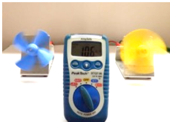
Abbildung 1: Aufbau zum Betreiben eines Motors (blaues Windrad) durch ein anderes Windrad (gelbes Windrad), das als Generator eingesetzt wird.
