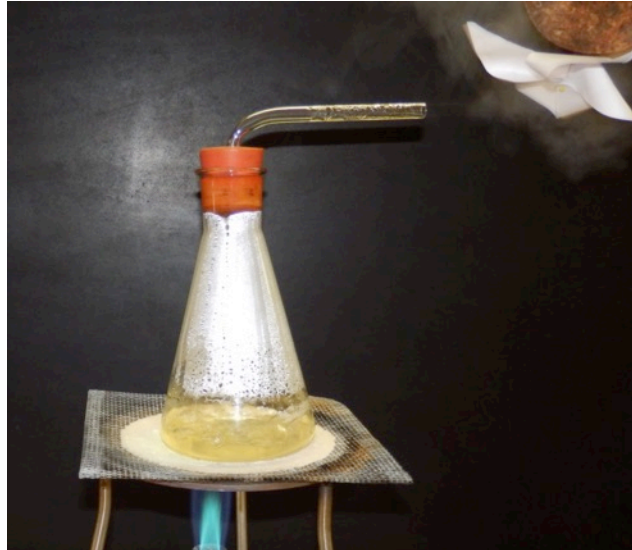
Abbildung 1: Ein Propeller wird bewegt, wenn er in den Wasserdampf gehalten wird..
